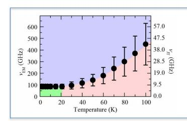
図2. 観測した周波数  $\nu_{EM}$  と軌道の揺らぎの周波 数 $\nu_{, | | |}$  の温度(Temperature)変化のグラフ。丸印 が各温度での揺らぎの周波数を表し、20 K 以下 で一定値(約 10 GHz, 100 ピコ秒)になる。
