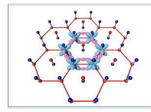
図1. 軌道液体状態の模式図。青い楕円体が銅の軌道で、赤い楕円体が酸素の軌道を表し、伸び縮みして動いているためにその平均構造を示している。
