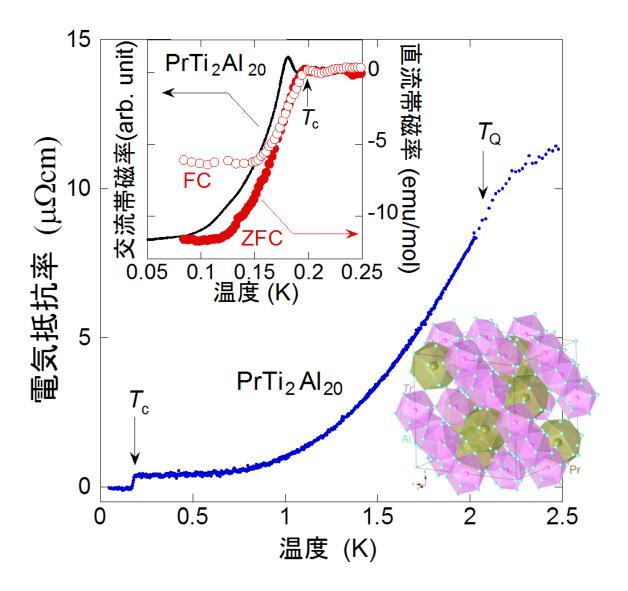
図 1. 電気抵抗率の温度依存性。2 K で強軌道秩序転移による電気抵抗率の減少が、0.2 K で超伝導によるゼロ抵抗が観測されました。超伝導転移直前の残留抵抗率は約 0.38 μΩcmと非常に小さく、サンプルの純度が極めて良いことを意味しています。(左上挿入図) 交流帯磁率(黒、左軸)と直流帯磁率(赤、右軸)の温度依存性。完全反磁性が十分出ていることから、この超伝導が(表面など試料の一部ではなく)試料全体で起きている本質的なものであることを示しています。(右下挿入図)PrTi<sub>2</sub>Al<sub>20</sub>の結晶構造。Pr(プラセオジム)原子が 16 個の Al(アルミニウム)原子に囲まれた籠状構造をしています。
