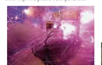
室内発生世界最高磁場1200Tを達成した電磁濃縮型超強磁場発生装置のほか強磁場下の実験環境も豊富です。
